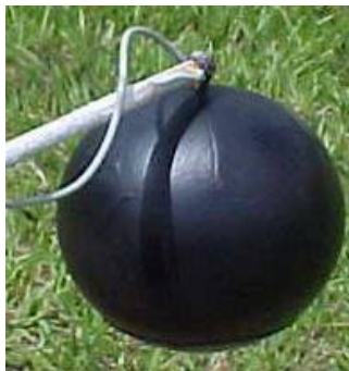
Figura 36 – Esquema de montagem do termômetro de globo negro.
