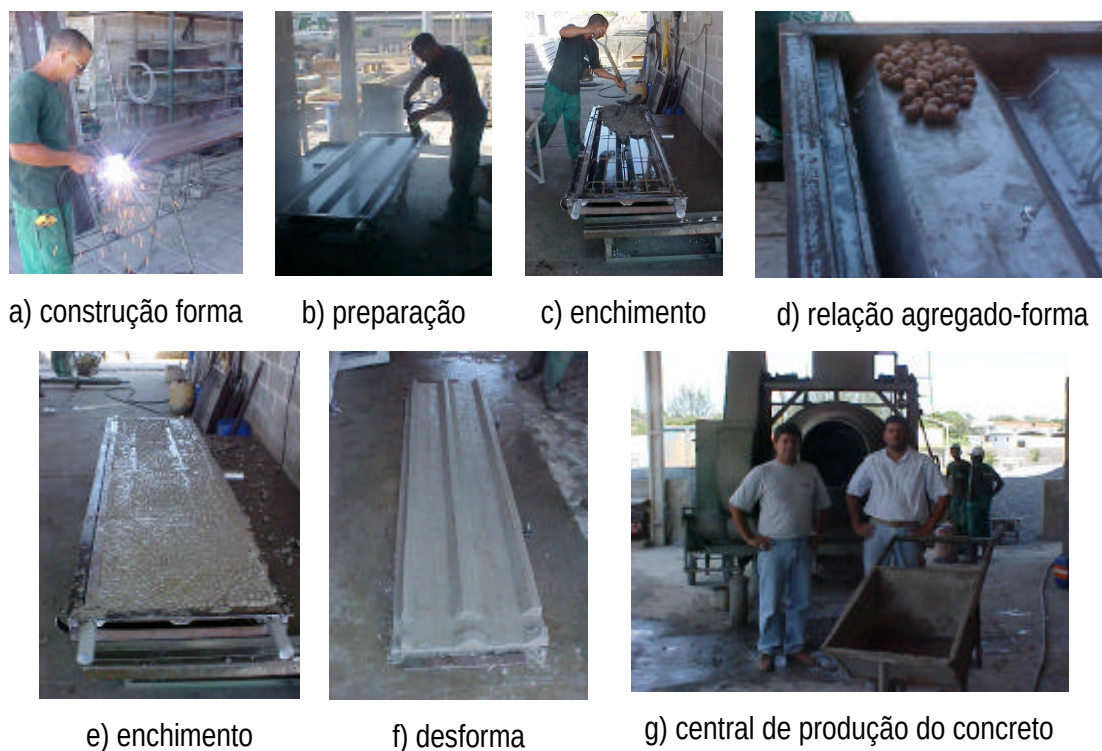
Figura 58. Processo de desenvolvimento e fabricação dos protótipos das telhas de concreto leve de argila expandida, em escala 1:1, SHED (2004).
