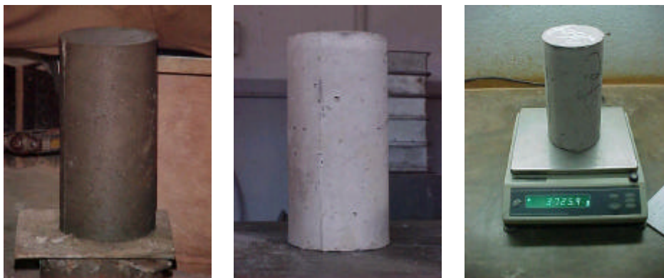
a) CP úmido, seco ao ar 24h fora câm. úmida. a) CP seco estufa, 24h 105° C. a) balança de precisão
