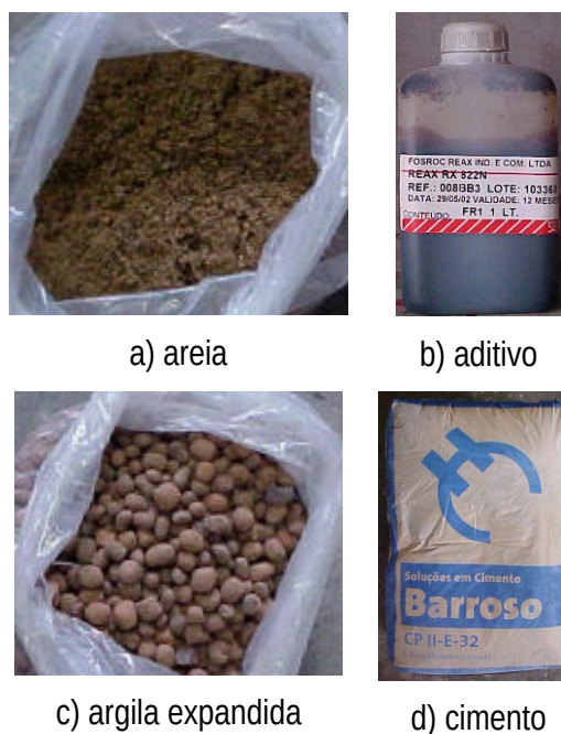
Figura 19. Materiais utilizados para obtenção do traço LWC.
