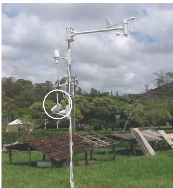
Figura 39 – Sensores externo (estação meteorológica digital OREGON).
