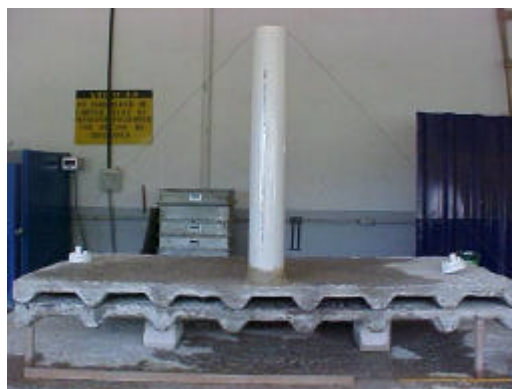
Figura 18 – Determinação da permeabilidade em placa de espessura variável.
