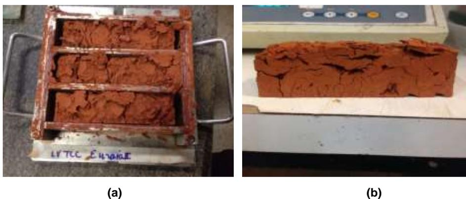
**FIGURA 29** - RETRAÇÃO (A), VAZIOS E DESPLACAMENTOS (B) - UMIDADE U3. FONTE: AUTOR
