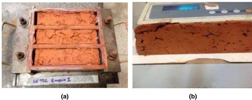
**FIGURA 28** - RETRAÇÃO (A), VAZIOS E DESPLACAMENTOS (B) - UMIDADE U2. FONTE: AUTOR
