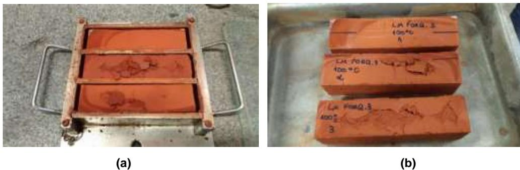
**FIGURA 27** – RETRAÇÃO (a), VAZIOS E DESPLACAMENTOS (b) - UMIDADE U1. FONTE: AUTOR
