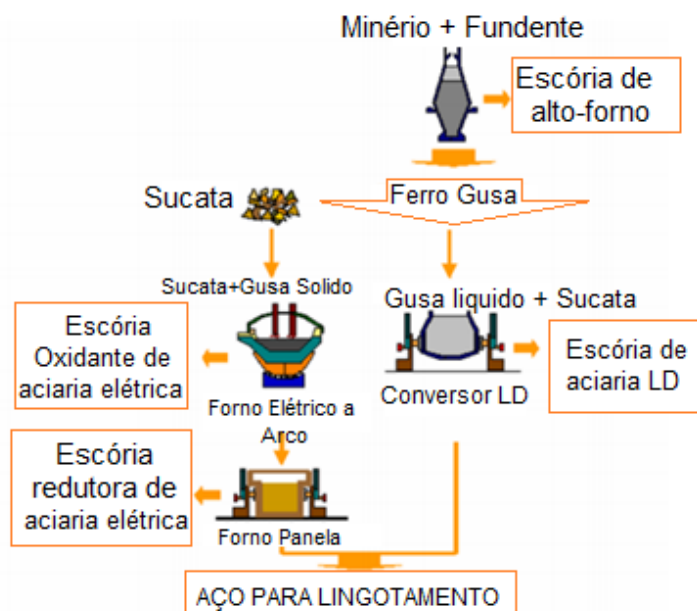
Figura 4 - Desenho esquemático da produção do aço. Fonte: (MASUERO, et al., 2004)
