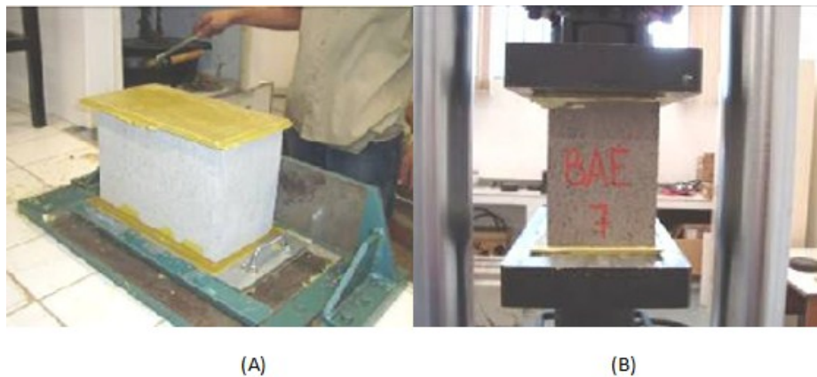
Figura 29 – A) Capeamento do bloco B) Ensaio de resistência a compressão
