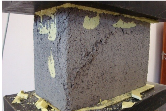
Figura 30 - Bloco após o rompimento
