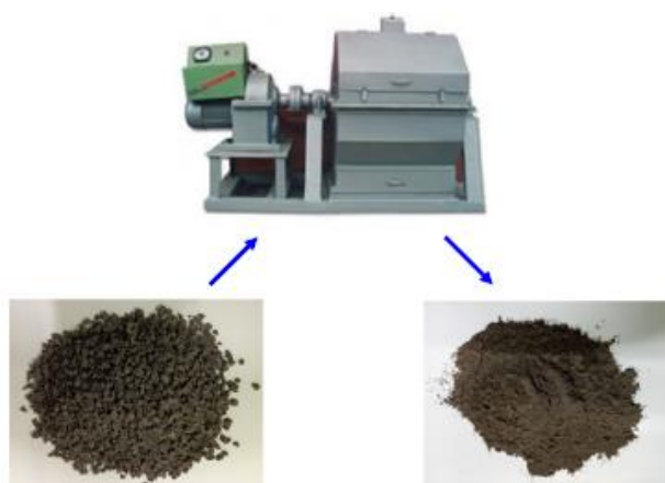
Figura 5: Moinho de bolas utilizado na preparação do powder de escória de aciaria (ZHAO, WANG, et al., 2016).
