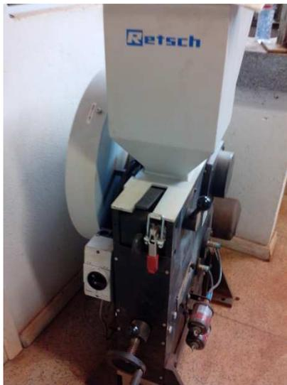
Figura 5.4: Britador de Mandíbulas
