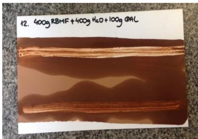
**Figura 24- PLACA APÓS EXECUÇÃO DO TESTE DE ABRASÃO DO TRAÇO 12**
