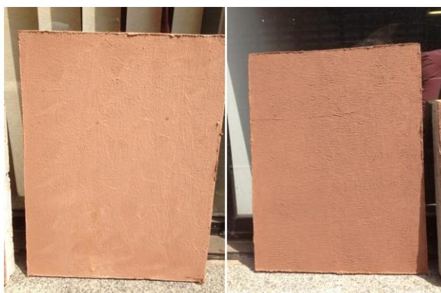
**Figura 30- À ESQUERDA TRAÇO CAL E À DIREITA TRAÇO RESINA**
