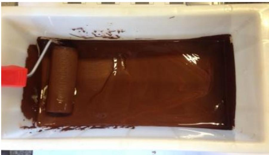
**Figura 13- TINTA SUSTENTÁVEL PRODUZIDA EM RECIPIENTE APÓS SAIR DO MISTURADOR**
