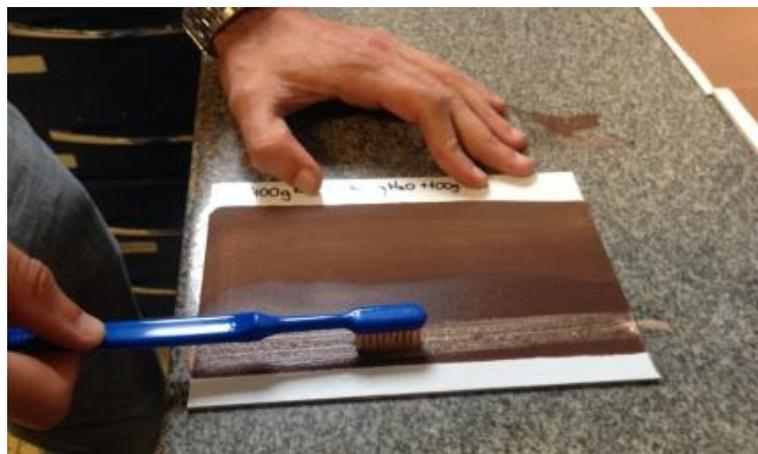
**Figura 23- TESTE DE ABRASÃO EM EXECUÇÃO**
