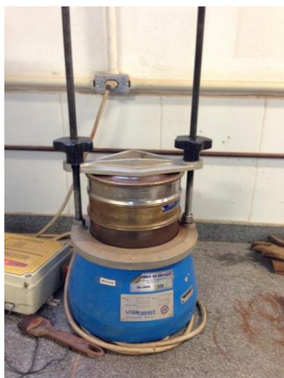
**Figura 7- AGITADOR DE PENEIRAS PARA RECOLHER MATERIAL
