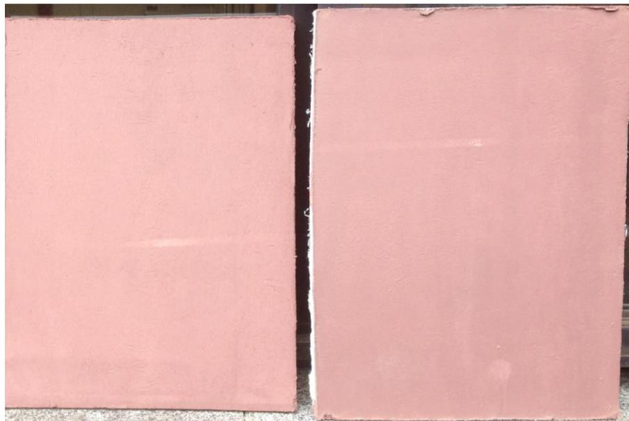
**Figura 38- Tinta Comercial Látex após 6 meses, à esquerda exposta no ambiente externo e à direita em ambiente interno**
