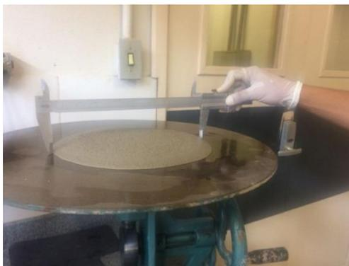
Figura 10: Medição do espalhamento da argamassa.
