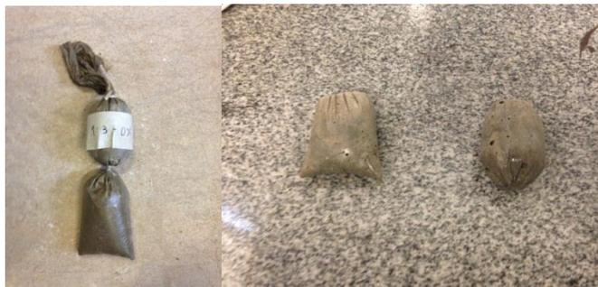
Figura 16: Modelagem dos corpos de prova para o calorímetro.
