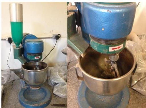
Figura 8: Misturador mecânico de argamassa.
