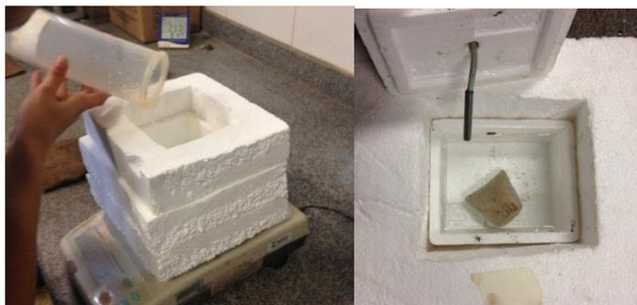
Figura 18: Preenchimento do calorímetro com água e adição do corpo-de-prova.
