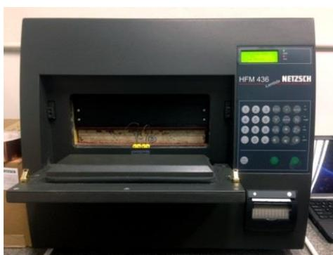
Figura 15: Equipamento HFM 436 Lambda, da fabricante NETZSCH.
