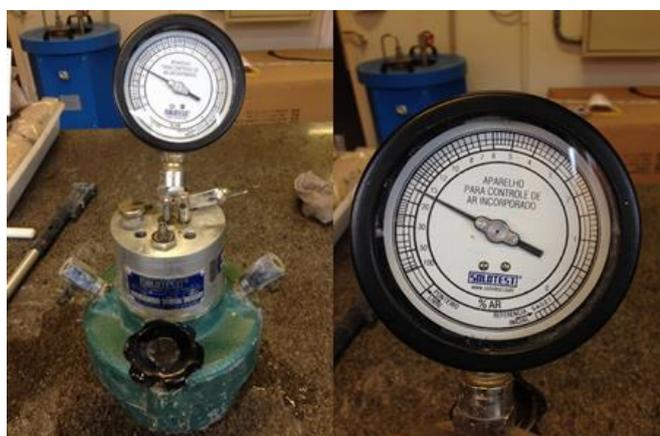
Figura 11: Equipamento para determinação do Teor de Ar Incorporado da marca SOLOTEST. (MENDES, 2016)
