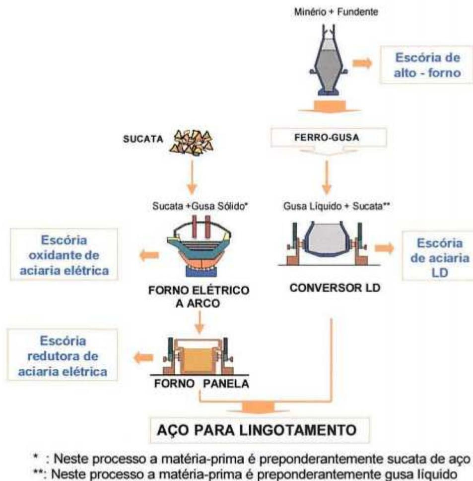
**Figura 5 - Representação esquemática dos processos de produção do aço e escórias geradas. Fonte: Masuero (2001)**
