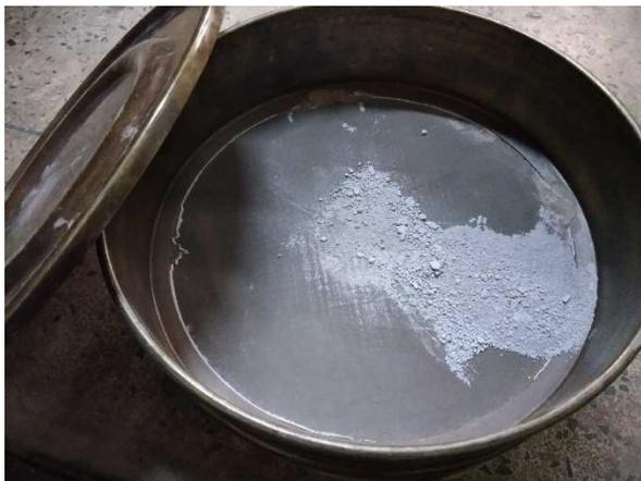
**Figura 13 - Peneiramento da pasta de cimento após moagem na idade especificada. Fonte: a autora.**
