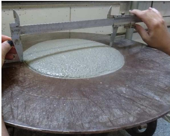
**Figura 9 - Medição do Índice de Consistência da argamassa. Fonte: a autora.**
