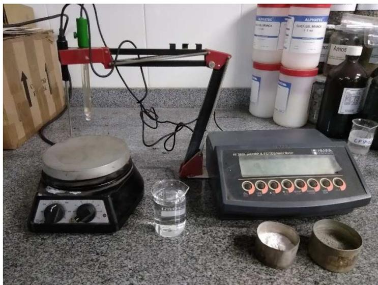
**Figura 6 - Materiais e Equipamentos para Ensaio de Condutividade Elétrica.**
