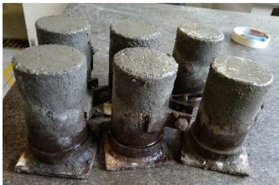
**Figura 10 - Corpos de prova recém moldados. Fonte: a autora.**
