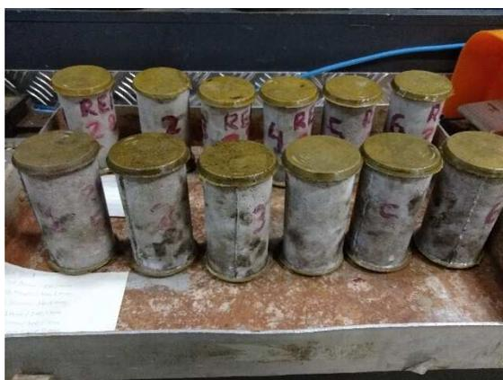
**Figura 12 - Corpos de prova capeados com enxofre para ensaio de resistência à compressão. Fonte: a autora.**
