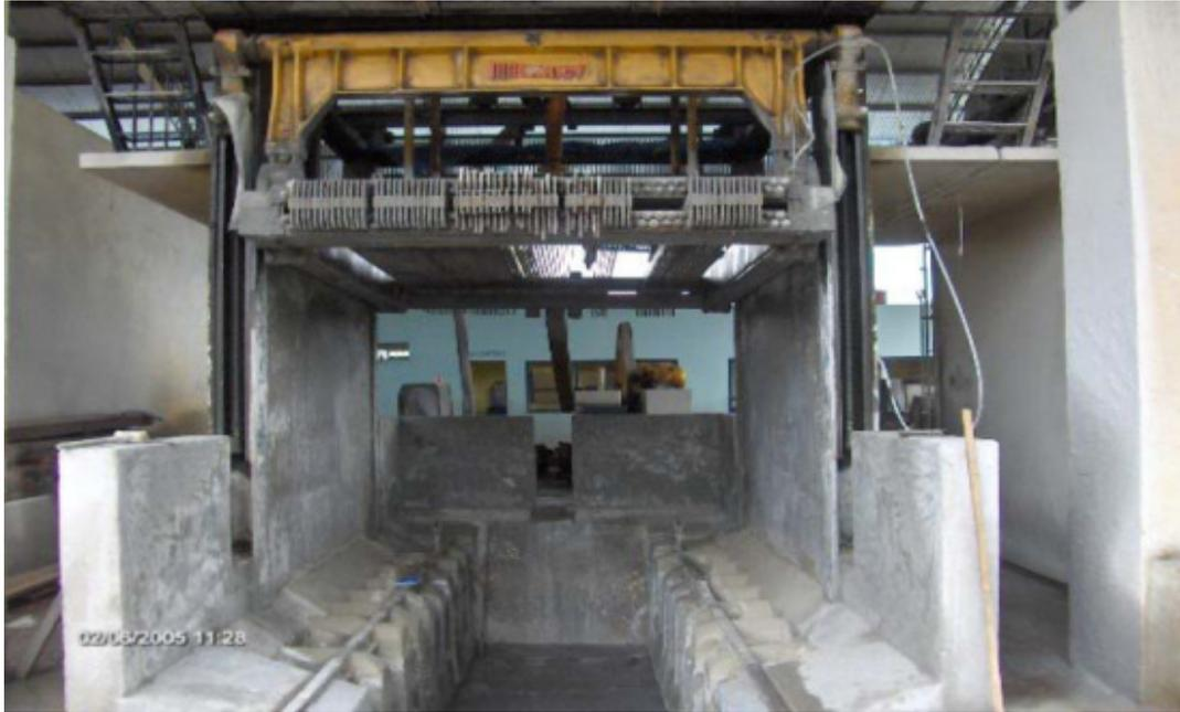
Figura 3.7 – Tear de Multi-lâminas (FILHO, 2006).
