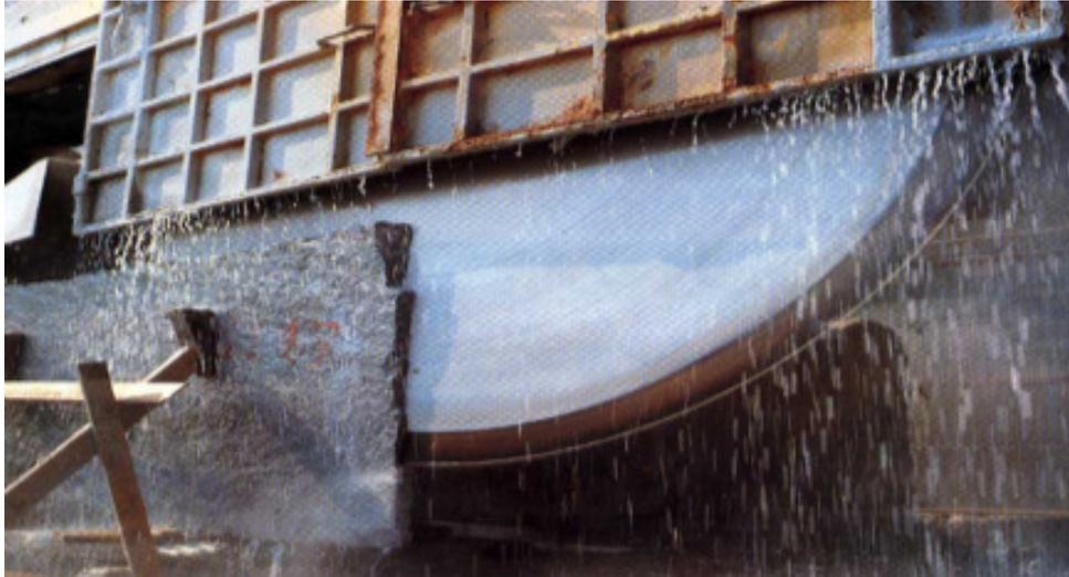
Figura 3.8 – Talha-bloco com Discos Diamantados (FILHO, 2006).
