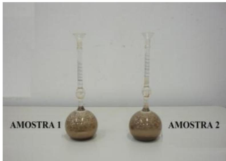
Figura 4.1 – Ensaio de Massa Específica do Cimento.
