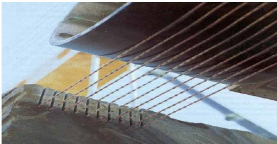
Figura 3.9 – Corte com Fios Diamantados (FILHO, 2006).
