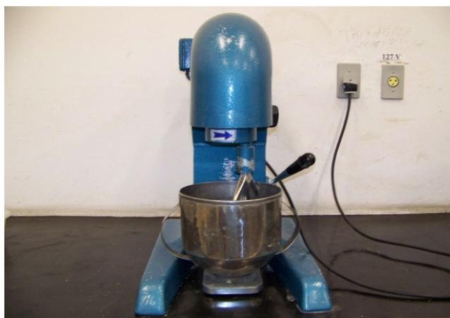
Figura 4.6 – Máquina de preparação da argamassa.
