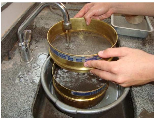
Figura 3.7: Ensaio para o teor de material pulverulento
