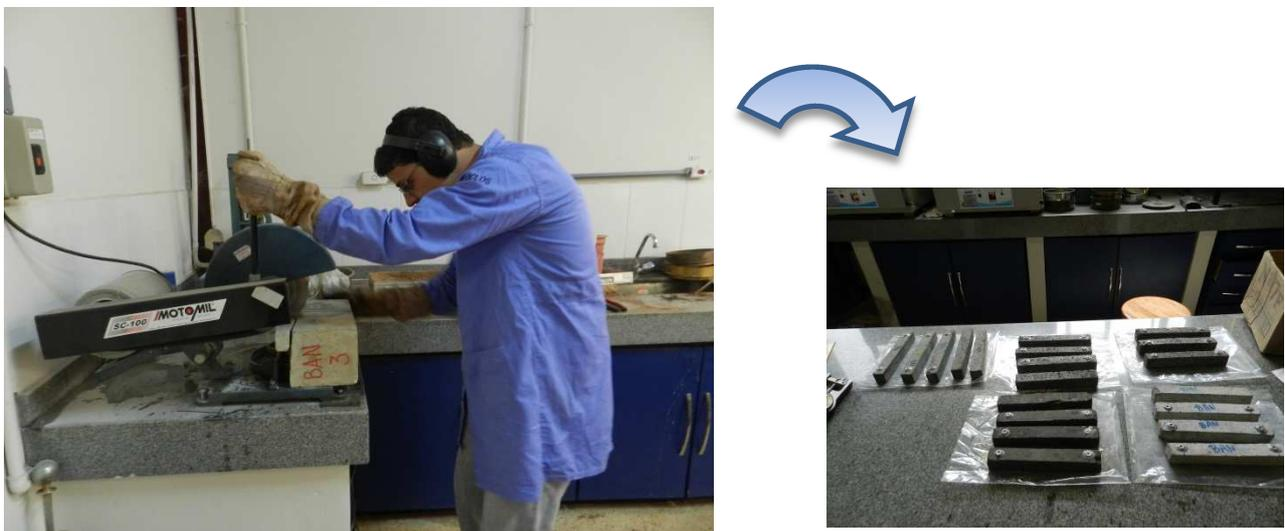
Figura 3.22: Produção dos corpos de prova a partir do corte dos blocos estruturais
