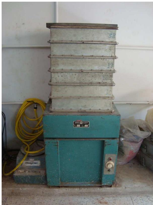
Figura 3.5: Análise granulométrica dos agregados graúdos
