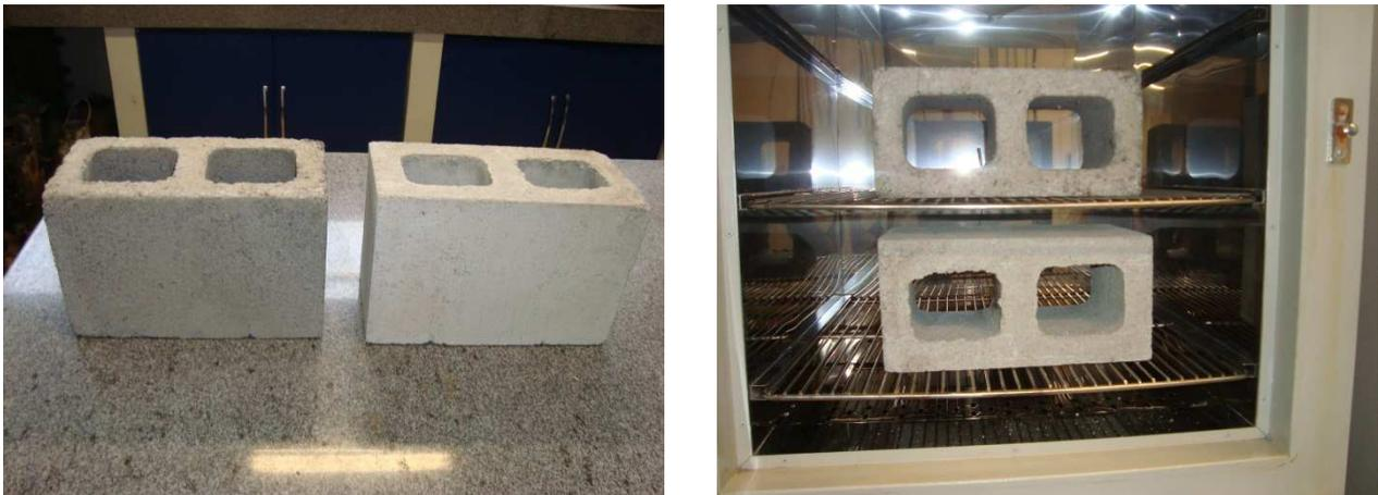
Figura 3.15: Determinação de umidade dos blocos
