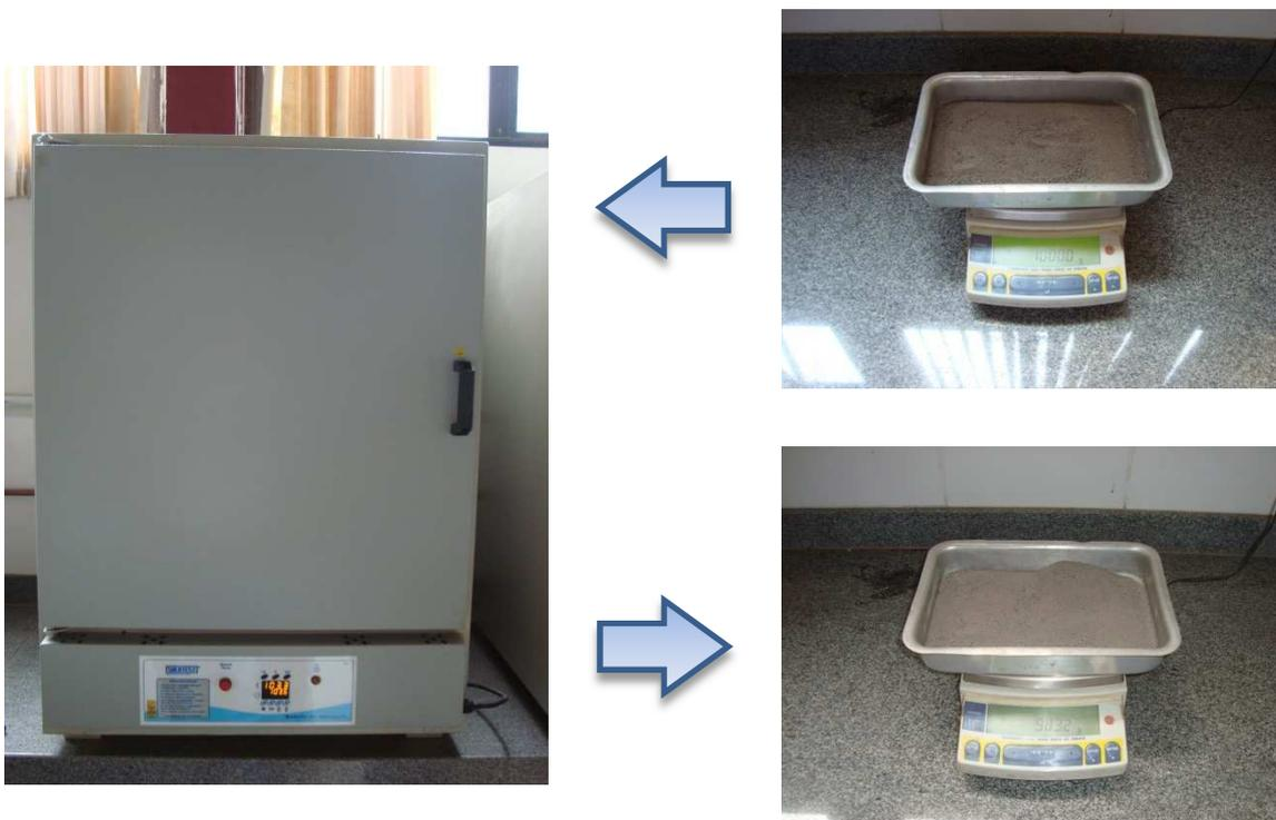
Figura 3.6: Processo para a determinação do teor de umidade dos agregados
