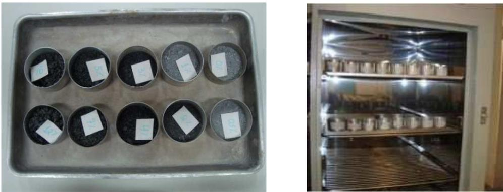
Figura 3.11: Determinação do teor de umidade para cada adição de água
