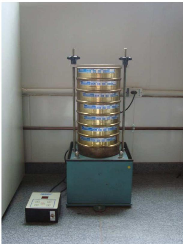
Figura 3.4: Análise granulométrica dos agregados miúdos
