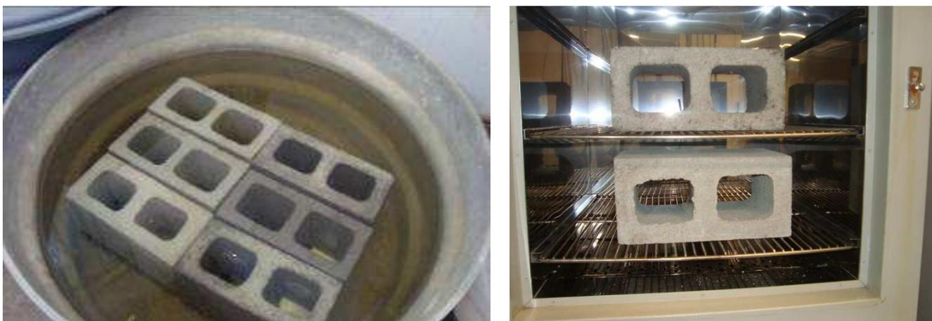
Figura 3.16: Determinação da absorção de água nos blocos
