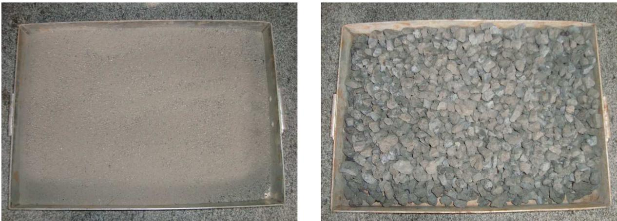
Figura 3.1 : Agregados miúdos e grãos produzidos com escória de aciaria.
