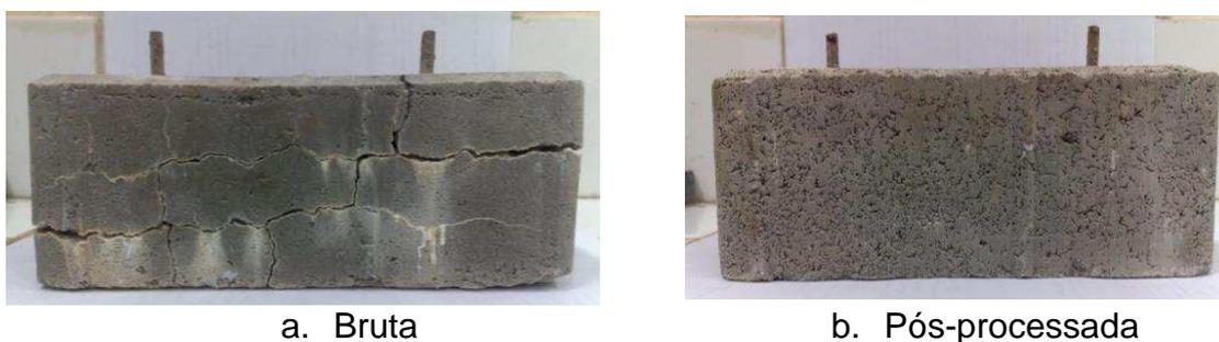
Figura 4.1: Bloco de concreto produzido com escória de aciaria
