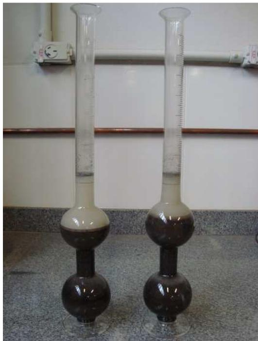
Figura 3.8: Determinação da massa específica do agregado miúdo de escória:
