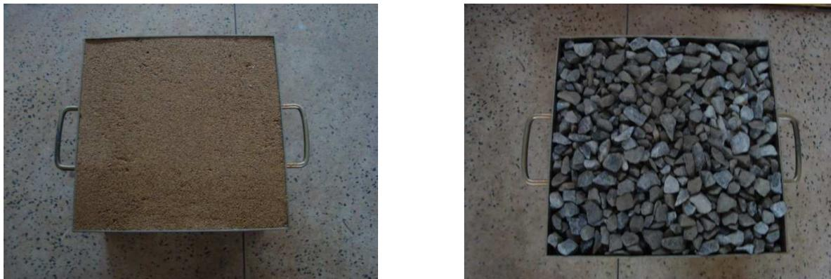
Figura 3.10: Determinação da massa unitária dos agregados
