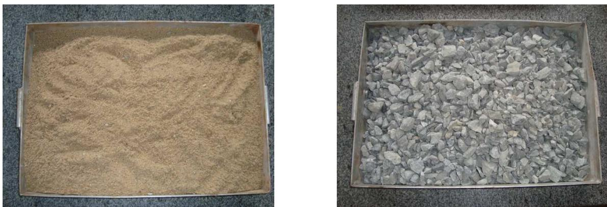
Figura 3.3: Agregados miúdos e graúdos provenientes de materiais naturais.
