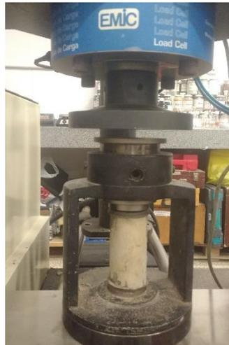
**Figura 16- Ensaio de determinação da resistência à compressão.**
