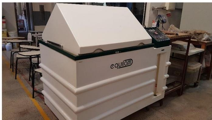
**Figura 13- Câmara de umidade utilizada.**
