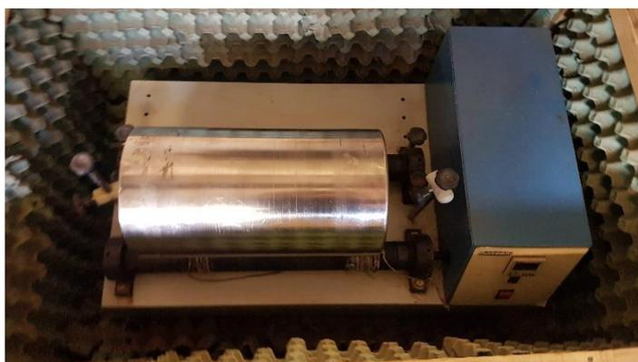
**Figura 7- Moinho utilizado no processamento da EFP.**
