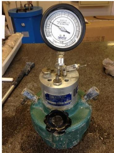
**Figura 15- Equipamento utilizado no ensaio de teor de ar incorporado.**
