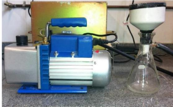
**Figura 11- Instrumentos utilizados no ensaio de determinação da retenção de água das argamassas pelo método do funil de Buchner.**
