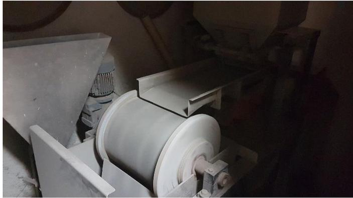
**Figura 6- Rolo magnético INBRAS utilizado para segregação dos materiais metálicos da EFP.**
