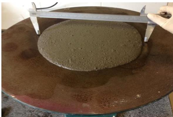
**Figura 10- Aferição de medida na mesa de consistência para determinação da plasticidade da pasta.**
