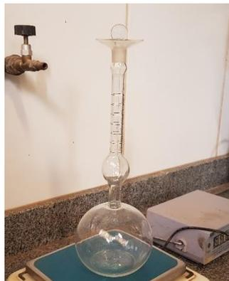
**Figura 8- Frasco de Le Chatelier utilizado no ensaio de determinação da massa específica.**
