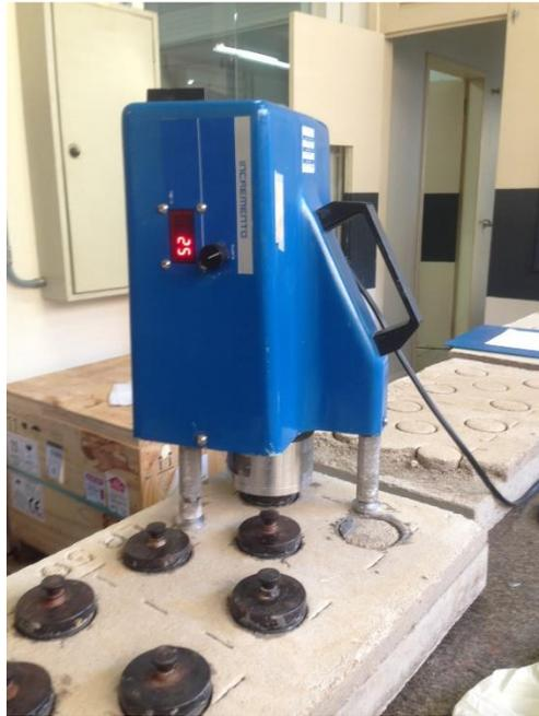
**Figura 18- Ensaio de determinação da resistência potencial de aderência à tração.**
