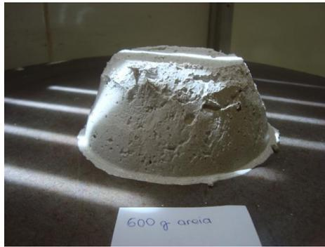
**Figura 12- Procedimento de determinação da capacidade de incorporação de areia do ligante.**
