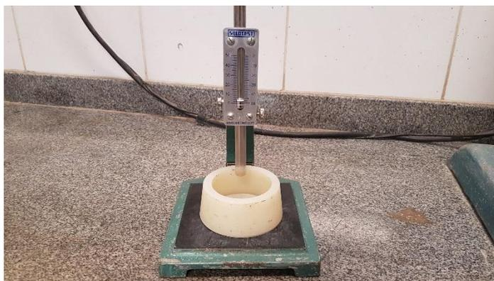
**Figura 9- Aparelho de Vicat modificado utilizado para realizar o ensaio de determinação da consistência normal.**
