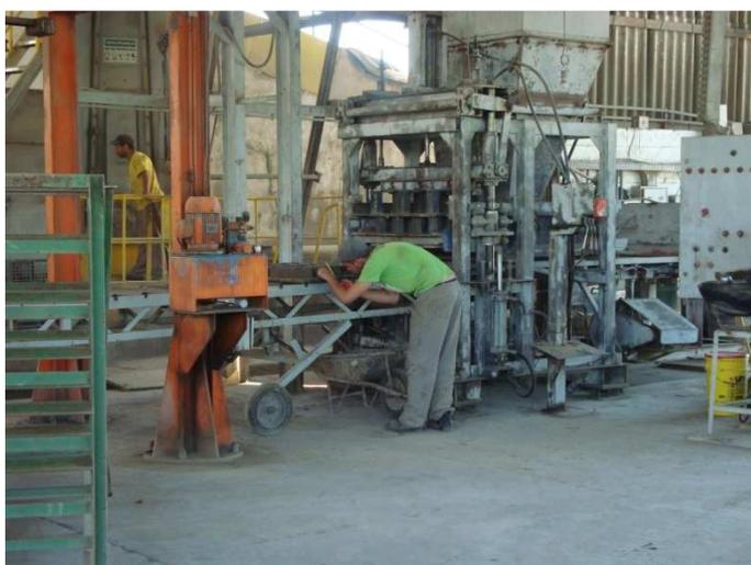
Figura 4.10: Vibroprensa
