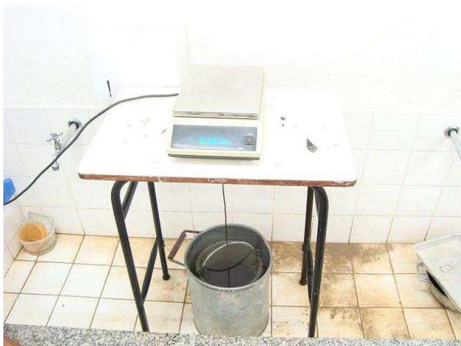
Figura 4.12: Pesagem hidrostática
