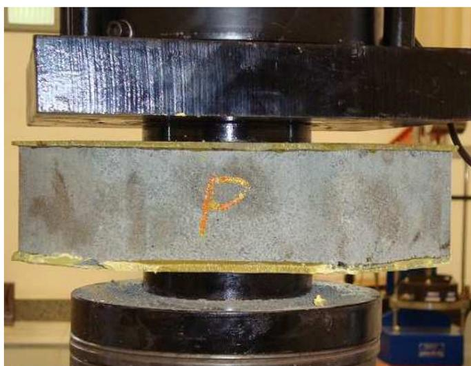
Figura 4.13: Rompimentos dos Pavers
