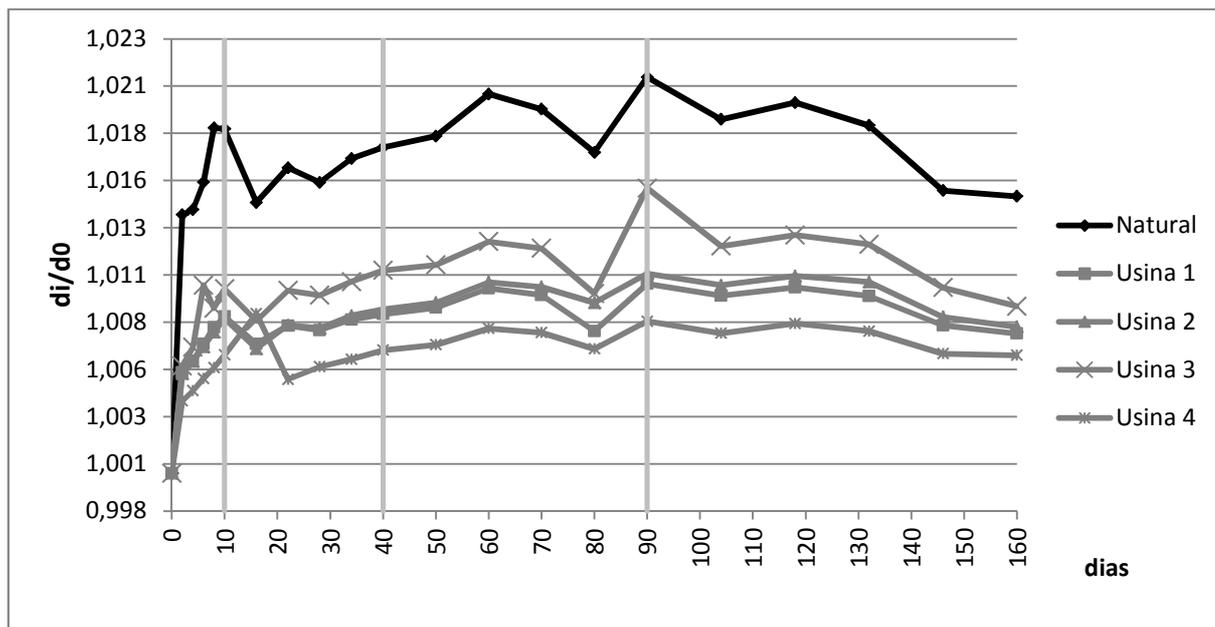
Figura 5.15: Variación paramétrica para densidade dos Pavers
