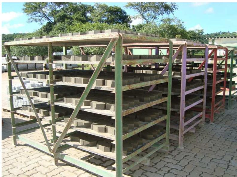
Figura 4.11: Acondicionamento dos elementos produzidos
