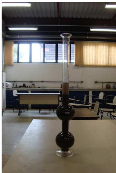
Figura 4.6: Massa específica - Agregado miúdo
