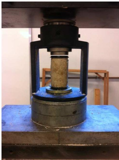
**Figura 6.3: Resistência compressão 7dias da EFP**
