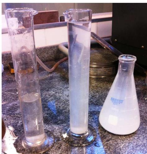
**Figura 5.11: Água presente na lavagem do material sobre o jogo de peneiras com abertura de malha de 0,75 mm e 1,18 mm**
