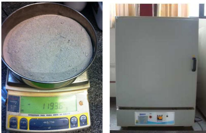
**Figura 5.8: Processo para a determinação do teor de umidade**
