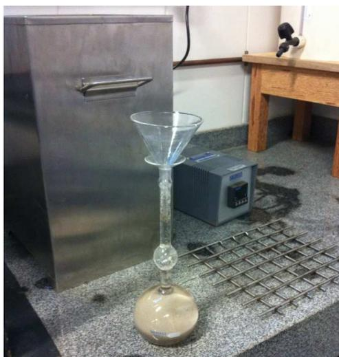
**Figura 5.7: Determinação da massa específica da escória Forno Panela**
