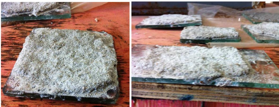
**Figura 6.5: 1ª observação das amostras após repouso de (18±2)h à temperatura de 40°C**
