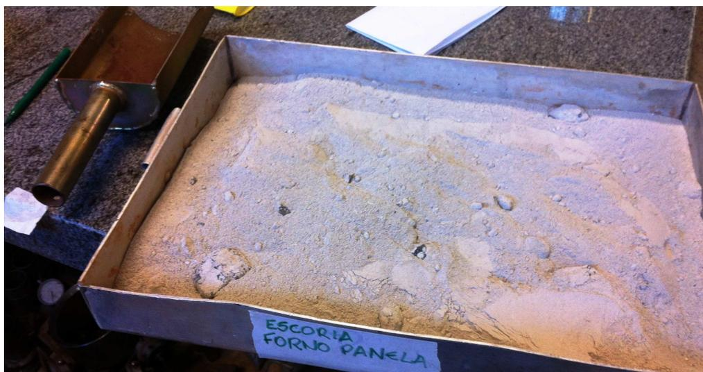
Figura 5.1: Amostra de escória utilizada nos ensaios
