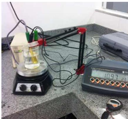
**Figura 5.9: Condutímetro utilizado**
