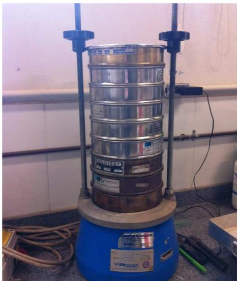
**Figura 5.6: Peneirador utilizado no ensaio**
