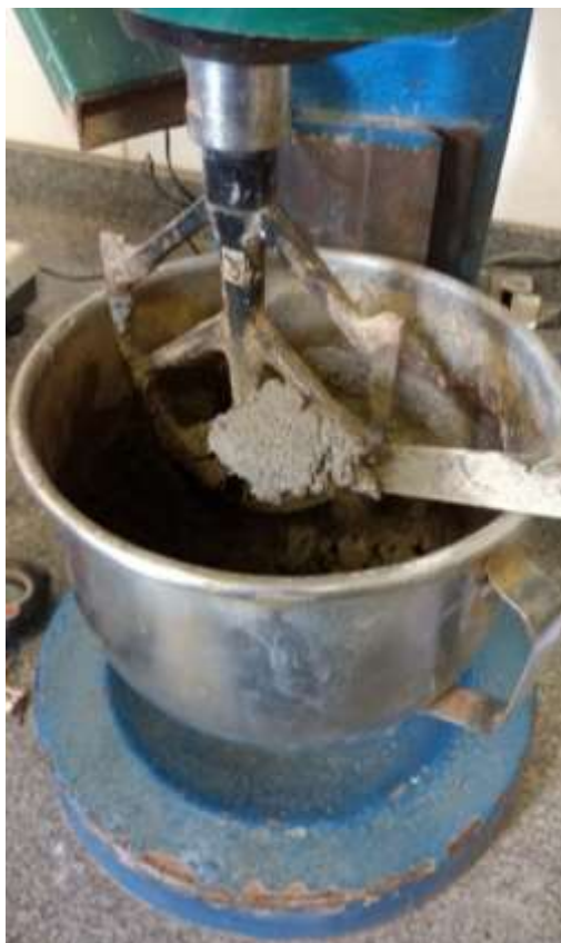
Figura 9 - Argamassadeira e argamassa produzida
