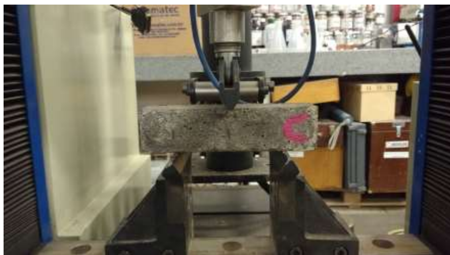
Figura 15 - Ensaio de Resistência à Tração na Flexão
