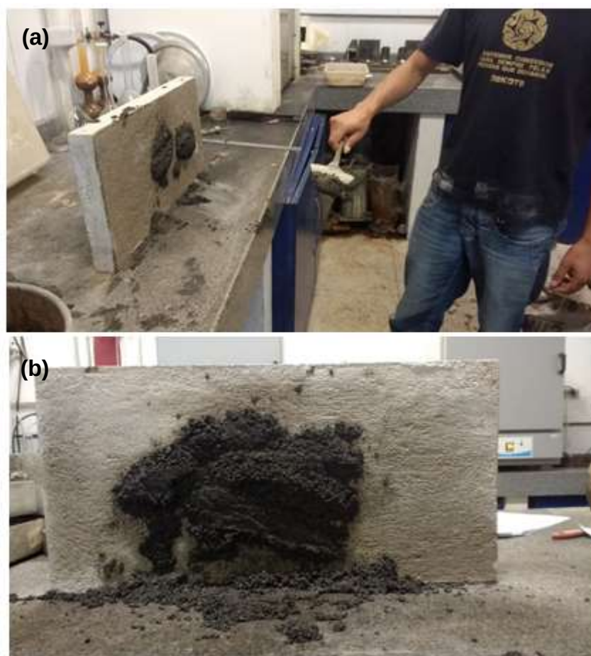
Figura 13 - Ensaio de adesão inicial. (a) lançamento da argamassa. (b) Material aderido ao substrato e "rebote".
