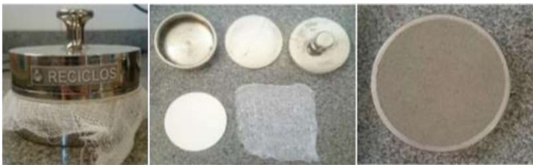
Figura 14 - Procedimento para ensaio de retenção de água
