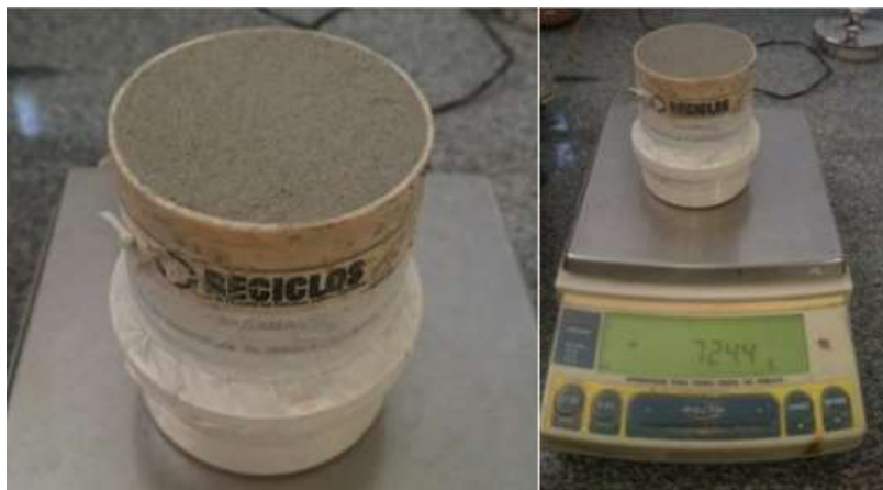
Figura 12 - Procedimento para ensaio de massa específica (densidade de massa)
