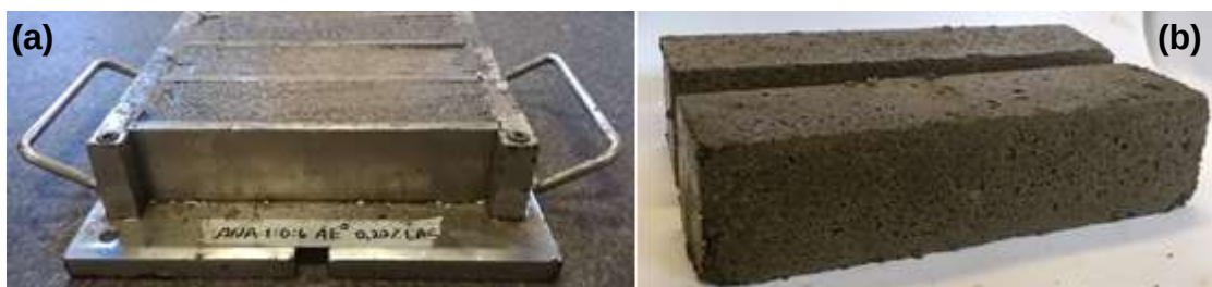
Figura 11 - Corpos de prova prismáticos 40x40x160mm. (a) Moldagem; (b) CPs após 03 (três) dias de cura.
