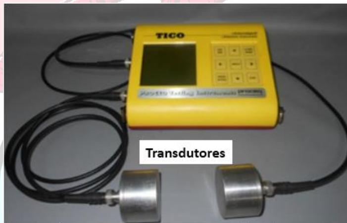
Figura 1 – Equipamento Tico marca proceq.
