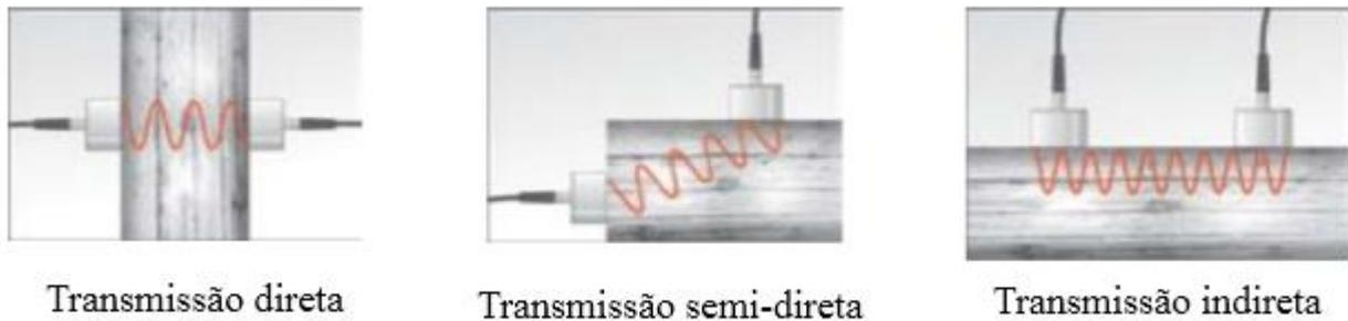
Figura 3 – Posicionamento dos transdutores.
