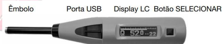
Figura 1 – Esclerômetro modelo SilverSchmidt Type N.
