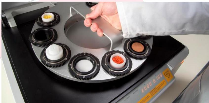
Figura 5 – Visão interior do espectrômetro de FRX.
