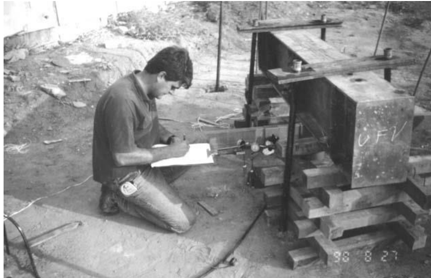
Figura 23 - Monitoramento das leituras dos deslocamentos e dos estágios de carregamento aplicados.
