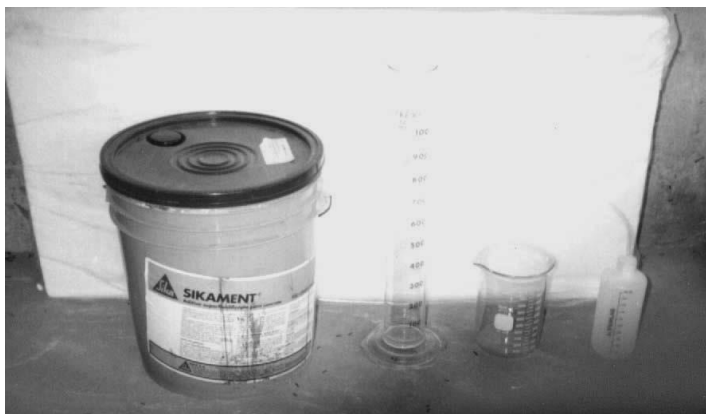
Figura 12 - Placa de isopor, tambor de 18 L de aditivo Sikament, proveta graduada 1.000 cm 3 , béquer graduado 500 cm 3 e almotolia graduada 200 cm 3 .
